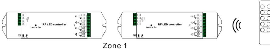
OPZIONE 2: I ricevitori sono in zone diverse (massima distanza per la sincronizzazione tra controllo master e slave è di 30m)
