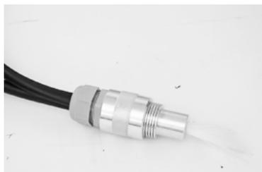
Con una mola eseguire il taglio delle fibre in eccedenza. Tagliare il più possibile vicino alla testa cercando di evitare di intaccare l'alluminio, per non sporcare le fibre con la polvere dello stesso.
