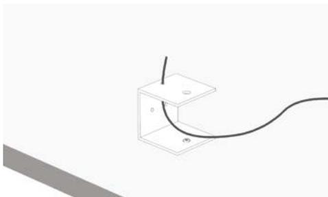
Bloccare le fibre con una fascetta di cablaggio nylon, facendola passare nei 2 fori laterali presenti nella staffa a C
