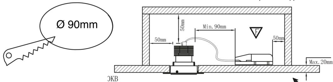
installare la controcassa alla lastra di cartongesso tramite viti
