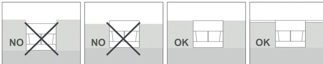
Se la pavimentazione prevede un'ulteriore finitura, calcolare lo spessore del materiale (es. legno, piastrelle...). La gettata perciò dovrà essere più bassa rispetto al filo dell'incasso dello spessore del materiale di finitura.
